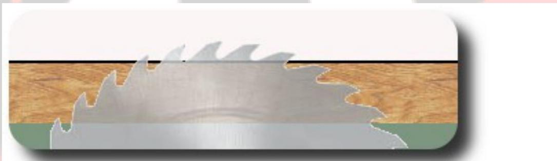
También el tamaño del diente debe ser adecuado al espesor de la madera que se va a cortar, recomendándose que la medida del paso de 4 dientes sea lo más aproximada posible al espesor de la madera, ya que tanto el ángulo de entrada como el de salida influyen en la calidad del corte, para una madera de 2" se debe usar una hoja de sierra que tenga un paso del diente aproximado a 3/4".
